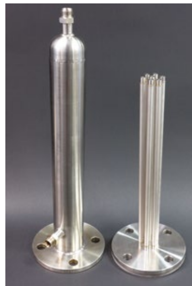
Prototype 7-tube, 700 cm 2 membrane module
